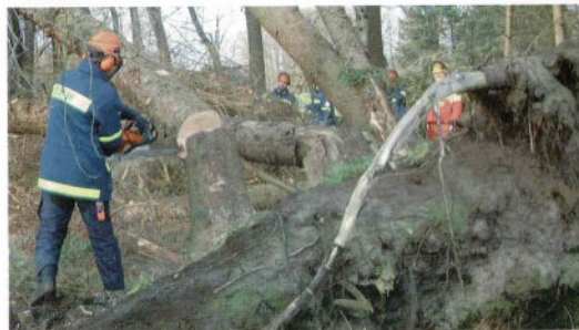
Nicht auszudenken, was passieren kann, wenn dieser Baumwurzelteller in seine ursprüngliche Position zurückklappt und der Sägeführer mit laufender Kettensäge in den Händen darauf nicht vorbereitet ist.
