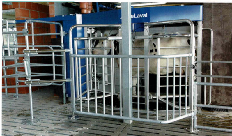
Bild: Hornberg. Die Kühe suchen mehrmals am Tag den Melkroboter auf, erhalten dort ein „Leckerli“ in Form von Kraftfutter und, werden dort gemolken. Der Computer hält fest, wie oft sich die einzelne Kuh dort eingefunden hat und wie viel Milch sie jeweils gegeben hat.
