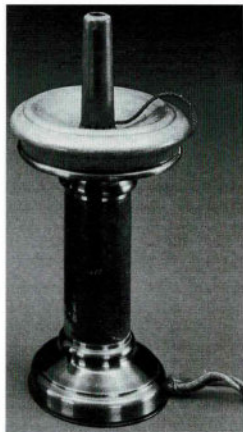
Gewöhnlicher Fernsprecher 1878 erstes Standardtelefon. Es konnte nur abwechselnd gesprochen oder gehört werden. Quelle: W. Blase, a.a.O. S. 39
