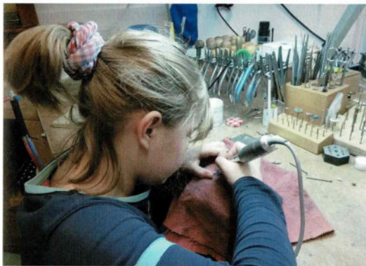
Dann wird der Stein eingesetzt und fest umbördelt
