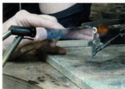
Anhänger und Fassung werden aufgelötet
