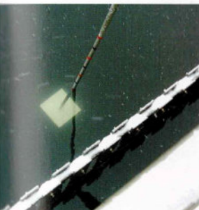
Der Ablauf nach Passage des Aktivkohlefilters. Auch bis in größere Tiefen ist das Wasser beinahe glasklar.
