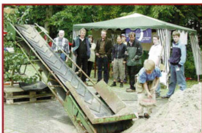
Sandbewegung mit einem Förderband, so wie früher die Baugruben ausgehoben wurden
