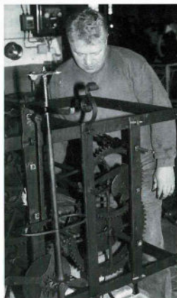
Restauriertes Räderwerk der alten Kirchturmuhr
